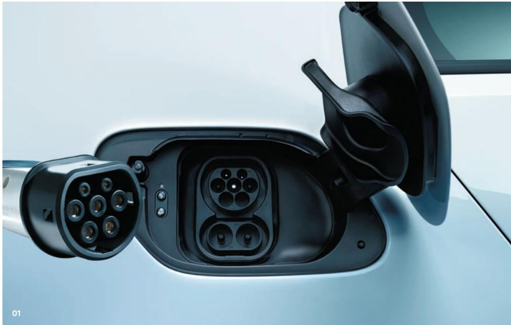
**01|02** Dank des **Combined Charging System (CCS)** braucht der e-Golf nur eine Ladedose zum Laden mit zwei verschiedenen Steckern: Wechselstrom über das Ladekabel für Netzsteckdosen, Ladestationen und die Wallbox – und Gleichstrom für schnelles Laden an öffentlichen CCS-Ladestationen. **S**
