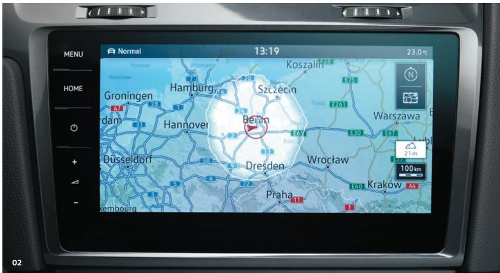
02 Im **Reichweitenmonitor** wird je nach ausgewähltem Fahrprofil die aktuell zu erwartende Reichweite grafisch dargestellt. Diese grafische Darstellung ist nur in Verbindung mit dem optionalen Navigationssystem „Discover Pro „möglich“. **SO**
