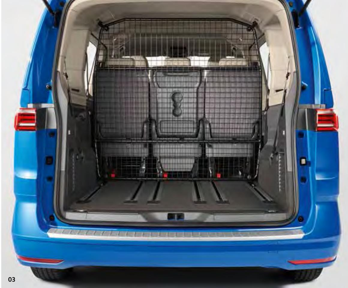
**03-04** Mit dem **Volkswagen Original Trenngitter (03)** teilen Sie beim New Multivan Fahrgastraum und Gepäckraum. Es ist eine wertvolle Hilfe beim Transport von Ladegut jeder Art oder beispielsweise auch beim Hundetransport. Der praktische **Volkswagen Original Ladekantenschutz (04)** aus transparenter Folie beugt Beschädigungen beim Be- und Entladen vor. Er wird einfach auf die Ladekante des Heckstossfängers aufgeklebt.
